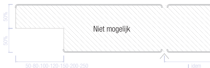
Type 2 Wand met inkeping en extra zaagsnede (beide zijden dezelfde kleur, niet met micro-profilering)
