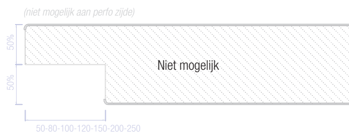
Type 1 Wand met inkeping (beide zijden dezelfde kleur, niet met micro-profilering)
