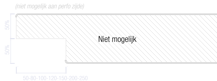
Type 1 Wand met inkeping (beide zijden dezelfde kleur, niet met micro-profilering)
