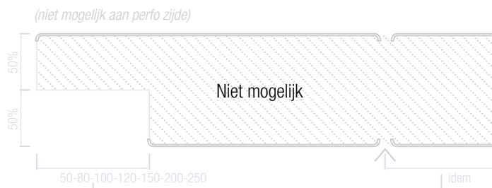
Type 2 Wand met inkeping en extra zaagsnede (beide zijden dezelfde kleur, niet met micro-profilering)
